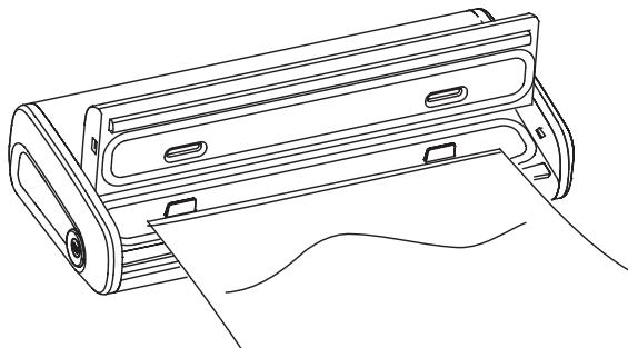
5. Закройте крышку, опустив ее и нажав сверху на ее края до упора и щелчка. Для удобства можно защелкнуть сначала один край крышки, а затем — другой. Следите при этом, чтобы пакет не сместился. Так как защелки тугие, при закрытии крышки нужно приложить небольшое усилие.
