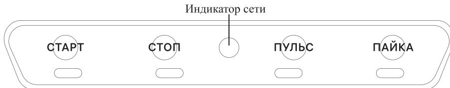
**Старт** — кнопка для автоматической упаковки. Вакууматор откачивает воздух из пакета, а затем запаяет его.
