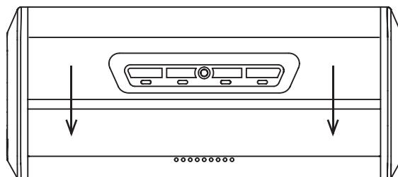
6. Нажмите кнопку «Старт» для вакуумирования и упаковки в автоматическом режиме. Вначале включится вакуумный насос для откачки воздуха, при этом под кнопкой «Старт» загорится индикатор. Затем индикатор загорится под кнопкой «Стоп», а после — под кнопкой «Пульс». Когда воздух будет откачен, автоматически включится нагреватель. Под кнопкой «Пайка» загорится индикатор.
