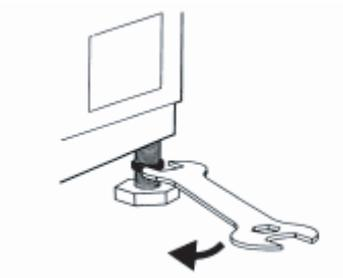
6. Немного приподнимите машину и, вращая ножку, отрегулируйте ее высоту.
