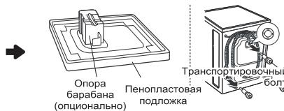
Снимите транспортировочные болты и опоры.
