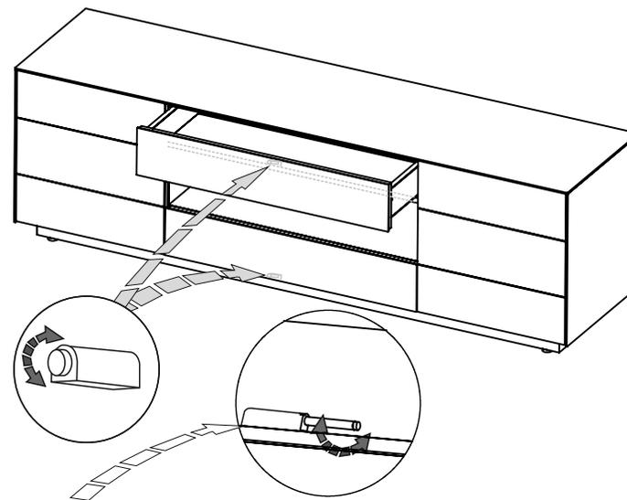
**!** Открытие и закрытие (фиксация) ящика может регулироваться вращением штока (стержня) толкателя. Регулировка производится при открытии ящика.
