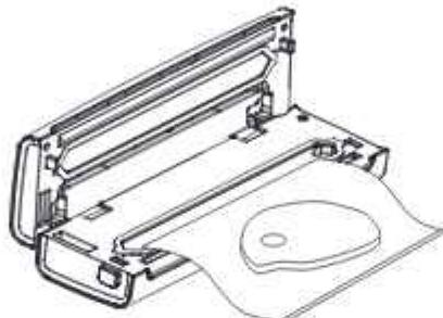
5. Закройте крышку, опустив ее и нажав сверху на ее края до упора и щелчка. Для удобства можно защелкнуть сначала один край крышки, а затем — другой. Следите при этом, чтобы пакет не смеялся. Так как защелки тугие, при закрытии крышки нужно приложить небольшое усилие.
