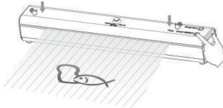
Подождите 2–3 секунды, чтобы шов застыл, затем потяните за клапан напуска воздуха, чтобы в вакуумную камеру попал воздух. Откройте крышку и выньте упакованный пакет.
