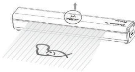
Перед следующим вакуумированием сделайте перерыв на 40 секунд для охлаждения запечатывающего элемента.
