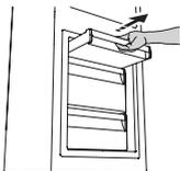
2. Отсоедините приспособление «STOP FROST» и извлеките его, стараясь не уронить его на стеклянную полку, расположенную ниже.
