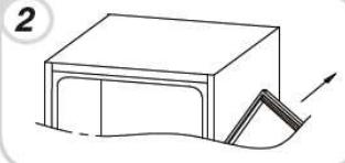
Снимите среднюю петлю и соединительный штырь снизу.
