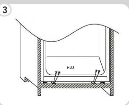
Установите на холодильник прокладку, при необходимости обрежьте лишнюю часть прокладки. Установите пластиковые крышки на нижнюю часть.
