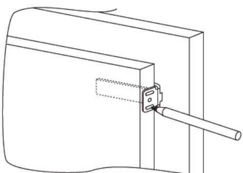
Соедините дверь с дверцей пенала для встраивания, используя вырезы в регуляторе подачи в качестве ориентира.
