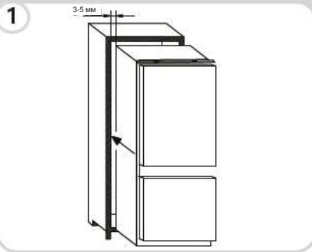
После этого, проверьте, что дверь холодильника соответствует двери секции, прикрепите винтами верхнюю часть холодильника к корпусу секции.
