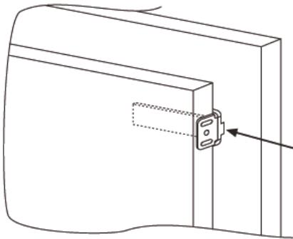
Отметьте точки крепления для винтов и просверлите отверстия сверлом диаметром 2,5 мм.
