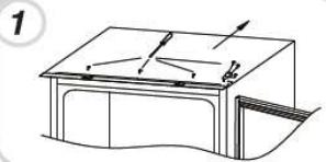
Снимите правую нижнюю петлю и пластиковые заглушки слева, и установите их с противоположной стороны.
