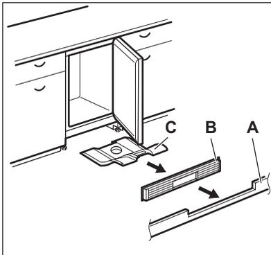
1. Снимите цокольную панель (А), а затем вентиляционную решетку (В).
