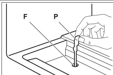
При нормальных условиях эксплуатации удаление инея с испарителя холодильной камеры происходит автоматически при каждом включении компрессора. Талая вода сливается в специальный поддон, установленный с задней стороны прибора над компрессором, где она испаряется.
