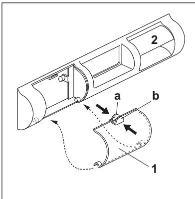
На вентиляционной решетке холодильника имеются фильтр входящего воздуха (1) и канал для вывода воздуха (2). Фильтр можно вынимать для очистки.
