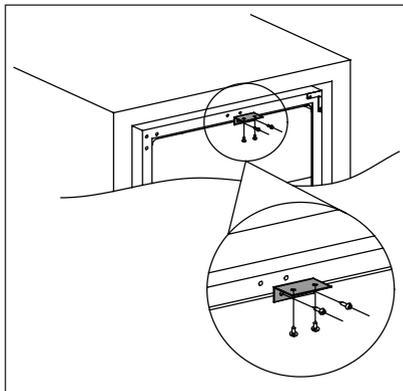
Використовуйте два гвинти, щоб встановити верхню скобу на верхній частині холодильника для вина, а потім вставте холодильник для вина у корпус і за допомогою двох гвинтів закріпіть верхню скобу на корпусі. Нижче наводиться малюнок для довідки.
