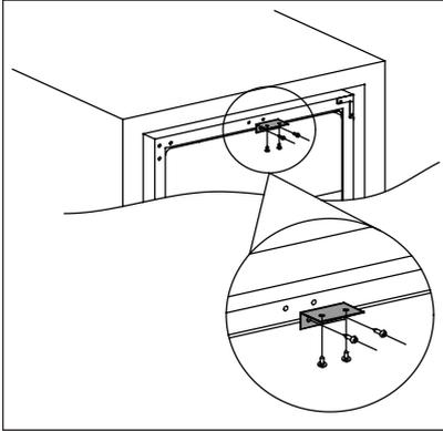
Použite dve skrutky na nainštalovanie horného koša na vrchnú časť chladiča vína, potom zasuňte chladič vína do skrinky a použite dve skrutky na upevnenie hornej mriežky na skrinku. Obrázok nižšie slúži ako referencia.
