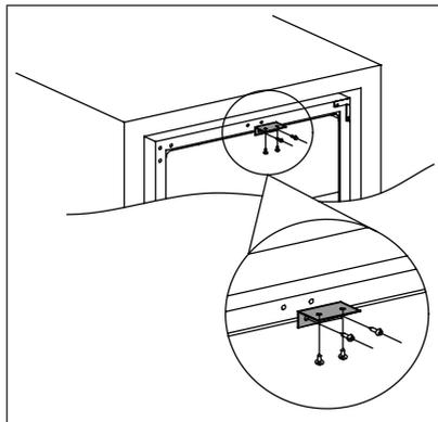
Au moyen de deux vis, posez la pièce de fixation supérieure sur le haut de la cave à vin, puis poussez la cave à vin dans l'armoire et attachez la pièce de fixation supérieure à l'armoire avec deux vis. Voir le schéma ci-dessous pour référence.
