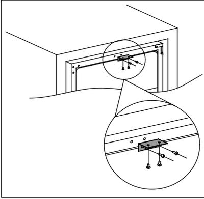
Utilizzare due viti per installare la staffa superiore sulla sommità della cantina, quindi spingerla nell'unità e usare le due viti per fissare la staffa superiore a quest'ultima. Fare riferimento al disegno sottostante.
