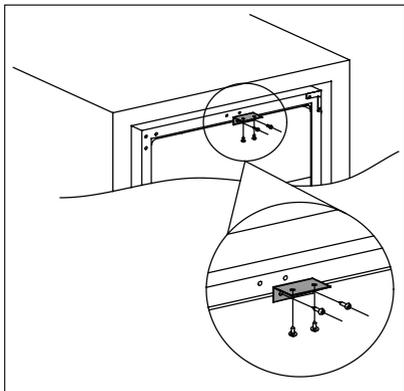
Закрепите скобу наверху холодильника для вин двумя винтами, затем задвиньте холодильник для вин в мебель и закрепите его скобу на мебели при помощи двух винтов. См. рисунок ниже.
