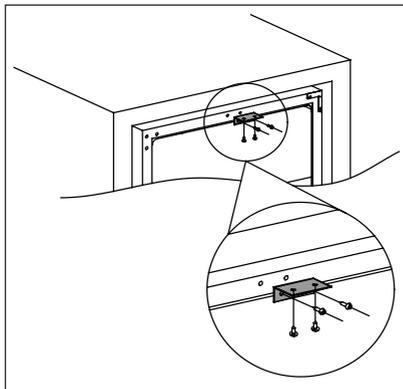
K instalaci horní konzoly na vrchní část vinotěky použijte dva šrouby a poté zatlačte vinotěku do skříňe a pomocí dvou šroubů připevněte konzolu na skříň. Níže je uvedené referenční vyobrazení.
