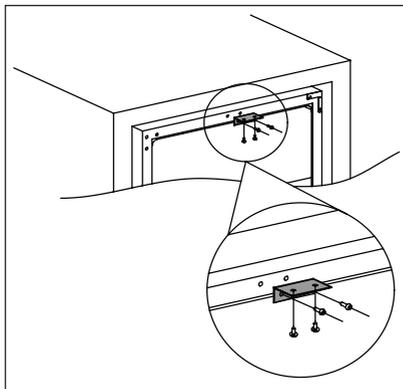
Brug to skruer til at installere det øverste beslag øverst på vinkøleren, og skub derefter vinkøleren ind i skabet, og brug to skruer til at fastgøre det øverste beslag på skabet. Nedenstående illustration til reference.
