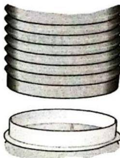
**Внимание!** Если диаметр вытяжной трубы и патрубок вытяжки не совпадают, используйте переходник.
