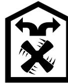
Вытяжка всасывает воздух, который очищается, проходя через жировоулавливающие и угольный фильтры, а затем возвращается обратно в кухню.
