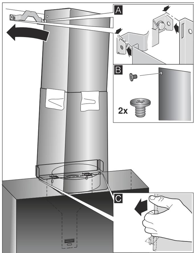
7. Зафиксируйте нижнюю секцию вытяжной трубы в крепежном уголке. Не допускайте повреждения сетевого провода! **C**
