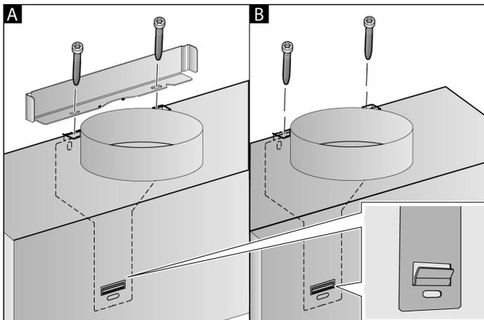
5. Если не монтируется канал, затяните два установочных винта без крепления. **B**
