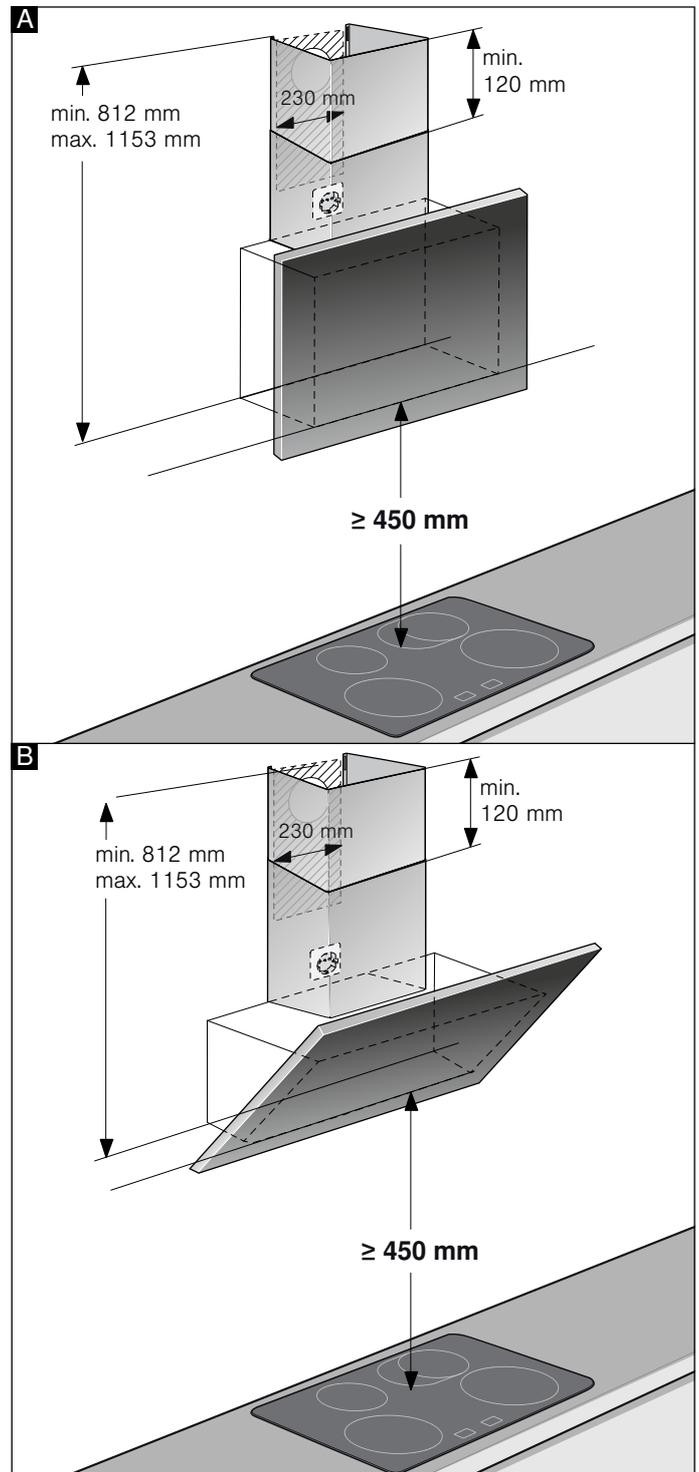
**Указание:** Мы рекомендуем устанавливать прибор таким образом, чтобы нижний край стеклянного экрана находился на одной линии с нижним краем соседнего навесного шкафа. Убедитесь в соблюдении указанных безопасных расстояний до варочной панели.
