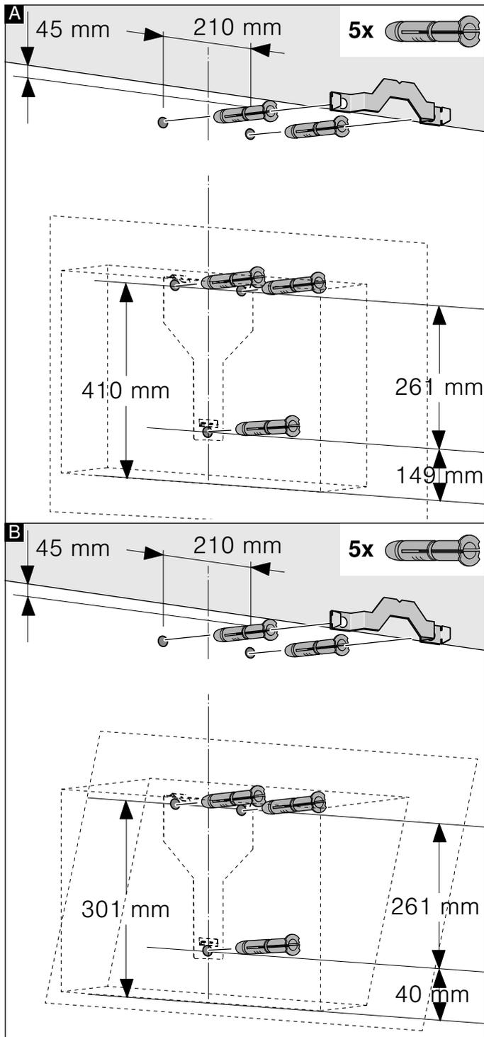
**Установка без обшивки вытяжной трубы**
