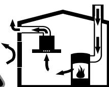
Источники пламени с подводом воздуха из помещения (например, работающие на газе, жидкое топливе, дровах или угле нагреватели, проточные водонагреватели, бойлеры) получают воздух для сжигания топлива из помещения, где они установлены, а отработавшие газы отходят через вытяжную систему (например, вытяжную трубу) из помещения на улицу.
