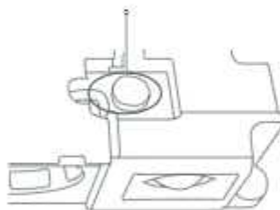
Sensore a infrarossi umano e obiettivo ottico di Fresnel
