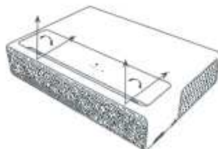
Zakres działania czujnika w pionie: około 55°
