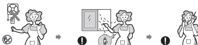
\* Топливный газ содержит меркаптан, чтобы вы могли почувствовать запах газа, запах гнилого чеснока или протухшего яйца), даже если в воздухе только 1/1000 газа.
