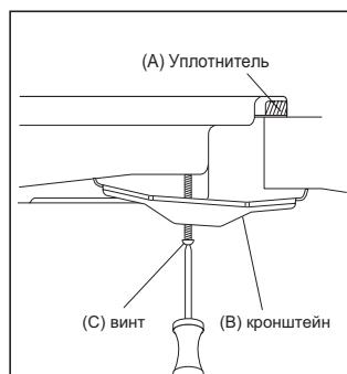
1. Поместите кронштейн (B) над отверстиями, которые соответствуют размеру винтов. В каждом углу плиты (H) есть один набор отверстий для винтов. Слегка затяните винт (C) через кронштейн (B), чтобы кронштейн прикрепился к плите, но так, чтобы вы могли отрегулировать его положение.
