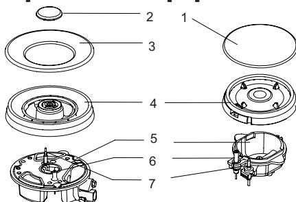
1. Поместите рассекатель ( 4 ) на чашу конфорки ( 5 ) так, чтобы свечи зажигания и устройство контроля пламени прошли через соответствующие им отверстия в рассекателе. Рассеиватель пламени должен быть правильно вставлен на место.
