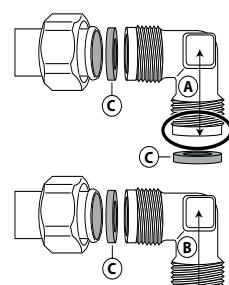
**ВАЖНО:** Перед подсоединением снимите транспортировочную заглушку с трубопровода газовой плиты.
