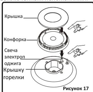
После зажигания зрительно проверьте пламя. Если вы видите пламя с желтым верхом, приподнятое или неустойчивое пламя, выключите подачу газа и проверьте соединение крышек и конфорок горелки (рис. 17). Также убедитесь, что в крышку горелки не попала жидкость. Если пламя горелки погасло, выключите горелку, проветрите кухню и повторно зажгите горелку через 90 сек.
