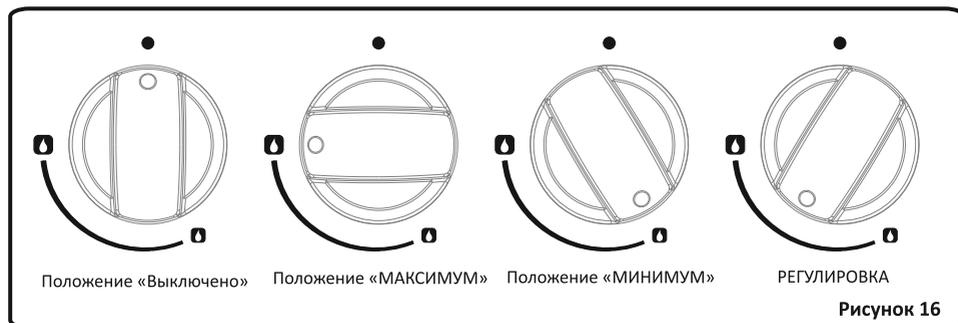
Есть 3 положения ручки: Выключено (0), максимум (значок большого пламени) и минимум (значок маленького пламени). Когда вы включили горелку на максимальную мощность, можно отрегулировать длину пламени между максимальным и минимальным положениями. Не используйте горелки, если положение ручки находится между максимальным и выключенным положениями.
