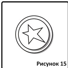
**Зажигание кнопкой розжига:** Нажмите на ручку горелки, которую необходимо зажечь, и поверните ее против часовой стрелки до максимального положения, а другой рукой одновременно нажмите на кнопку розжига (рис. 15). Нажмите на кнопку немедленно, потому что если вы подождете, то это может привести к накоплению газа и распространению пламени. Удерживайте кнопку розжига в нажатом положении, пока не увидите над конфоркой устойчивое пламя.
