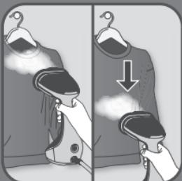
**NO** Trykk på dampknappen med dampbørsten vendt bort fra deg og hold den i vertikal stilling.
