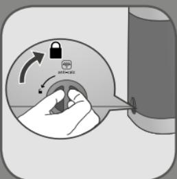
**PL** Odłóż z powrotem zawór spustowy, całkowicie przykręć aż do całkowitego zablokowania i sprawdź, czy nie ma wycieków.
