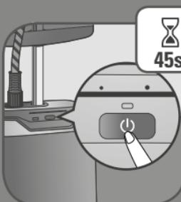
**SV** Tryck på PÅ/AV-knappen för att slå på apparaten. Lysdioderna blinkar i ca 45 sekunder.
