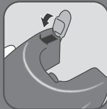
**RU** Закройте пробку водозаборного отверстия.
