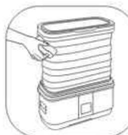
Reinigen Sie die Blende mit einem feuchten weichen Tuch oder gut ausgewringten Schwamm.
