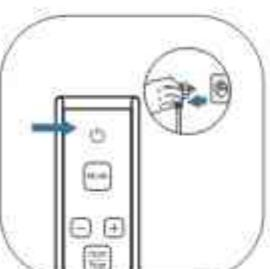
Izsledziet ierīci un atvienojiet to no elektrotīkla. Pāgaidiet stundu, līdz ierīce ir pilnībā atdzisusi.
