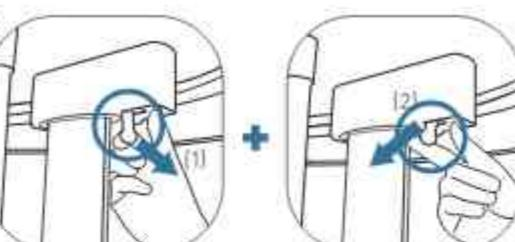
Разблокируйте фиксаторы верхней крышки, потянув их на себя [1], а затем сложив их внутрь [2]. Снимите верхнюю крышку.
