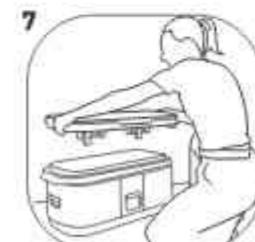
Ant pagrindo uždėkite viršutinį dangčių.
