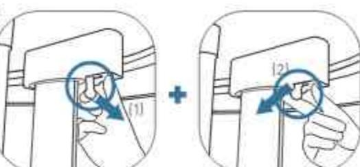
Zámky horního krytu odjistěte tak, že zatáhněte směrem k sobě [1] a následně sklopite spotřebič směrem dovnitř [2]. Sejměte horní kryt.
