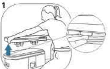
1-Heben Sie die Blende leicht an, um zu den Griffen zu gelangen. Drücken Sie die Griff zum Verriegeln/Entriegeln der Blende ein, und entfernen Sie dann die obere Abdeckung von der Basis.
