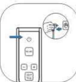
Выключите прибор и отсоедините его от электросети. Подождите один час, пока прибор полностью остынет.
