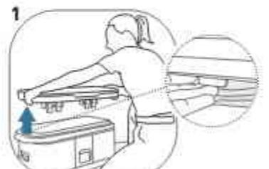
1-Приведите вперед, чтобы получить доступ к рукояткам на ручке блокировки щитка, затем снимите щиток с крепления.
