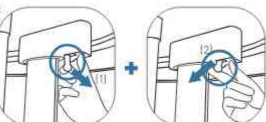
Lösen Sie die Verriegelungen der oberen Abdeckung, indem Sie sie zu sich ziehen [1] und dann nach innen klappen [2]. Entfernen Sie die obere Abdeckung.
