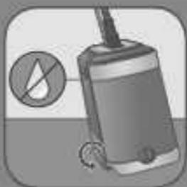
**PL** Upewnij się, że pojemnik na wodę jest pusty przed przesuwaniem urządzenia na kółkach.
