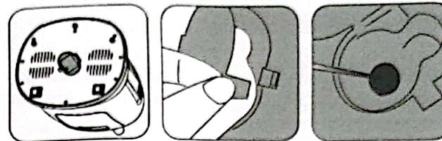
Используйте отверстие для воды для очистки нагревательного элемента и металлической заглушки
