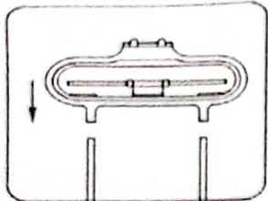
Поднимите крышку соединительного отверстия, извлеките гладильную щетку, совместите разъем гладильной щетки, вставьте ее в соответствующее отверстие на корпусе устройства и затяните по часовой стрелке. После использования вытяните гладильную щетку и закройте крышку.
