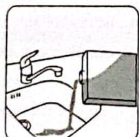
Разберите фильтр, промойте чистой водой , а также промойте все принадлежности и емкость для воды. По окончании поместите фильтр обратно на дно резервуара и затяните его по часовой стрелке.
