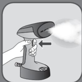
**DA** Når lyset lyser, skal du lukke noget damp ud, ved at holde damp-knappen nede og holde apparatet væk fra tøj.
