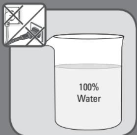
مخزن آب را تا حداقل حد آن با 100% آب لوله‌کشی پر کنید و این عملیات را دوباره تکرار کنید تا زمانی که مخزن آب کاملاً خالی شود و بعد دستگاه را تمیز کنید.
