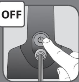
**DA** Hold tænd/sluk-knappen nede i 3 sekunder, for at slukke for apparatet.
