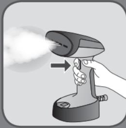
**TH** กดปุ่มไอน้ำโดยหันหัวไอน้ำออกจากตัว และถือในตำแหน่ง
