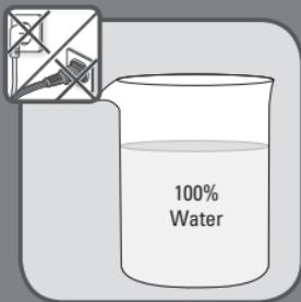
**DA** Fyld vandbeholderen med 100 % ubehandlet vand fra hanen og lad apparatet køre, indtil vandbeholderen er helt tom, så apparatet skylles.
