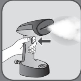
وقتی چراغ ثابت شد، دکمه بخار را مکرراً و به دور از لباس فشار دهید تا بخار آزاد شود.
