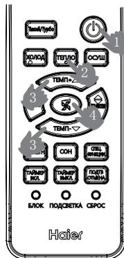
1. Для включения кондиционера нажмите кнопку ON/OFF, кондиционер включится в работу согласно последнему выбранному режиму.
