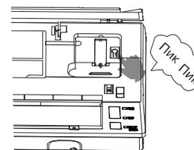
Для выключения кондиционера нажмите на кнопку **EMERGENCY SWITCH**. При этом Вы услышите одиночный звуковой сигнал, подтверждающий выключение кондиционера.
