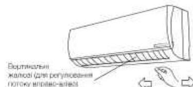
Напрямок повітряного потоку в горизонтальній площині змінюється вручну поворотом вертикальних жалюзів.
