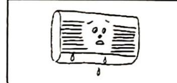
При включении или выключении кондиционера может быть легкое "постукивание". Это обычный звук циркуляции хладагента (охладителя).
