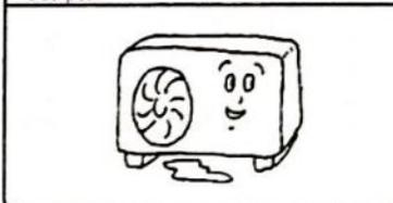
При работе кондиционера в режиме Обогрев, может образовываться пар при разморозке.
