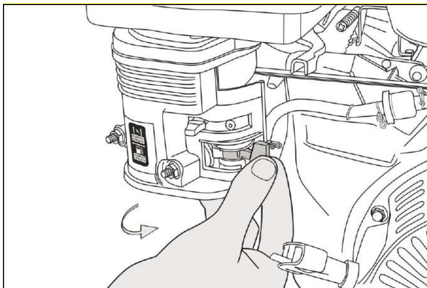
Рис. 21 «Открытие топливного крана»
