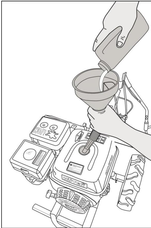
Рис. 20 Заливка бензина
