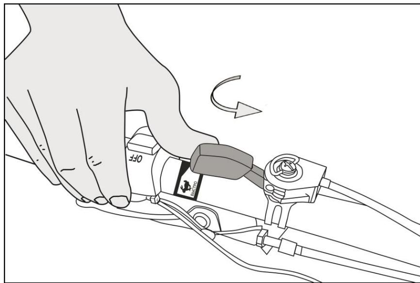
Рис. 26 Перевод ручки газа в максимальное положение
