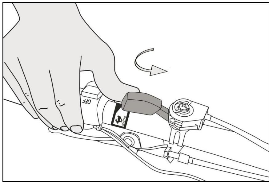
Рис. 28 Перевод ручки газа в максимальное положение
