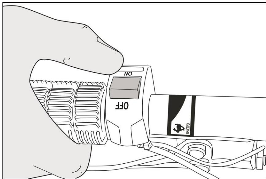
Рис. 23 Включение зажигания
