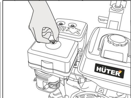
Рис. 37 Закрытие крышки корпуса воздушного фильтра
