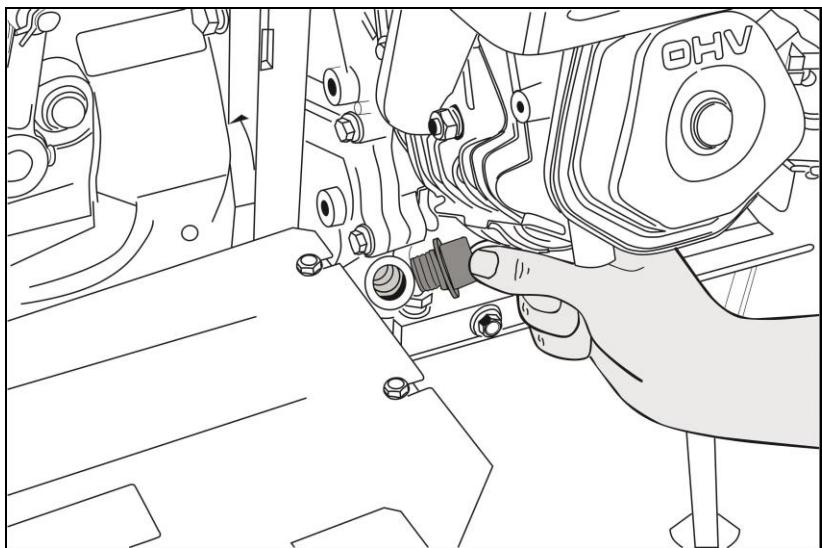
Рис. 13 Откручивание крышки
