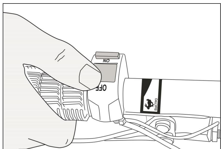
Рис. 33 Выключение зажигания
