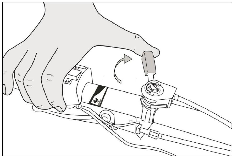
Рис. 32 Установка рычага газа в минимальное положение
