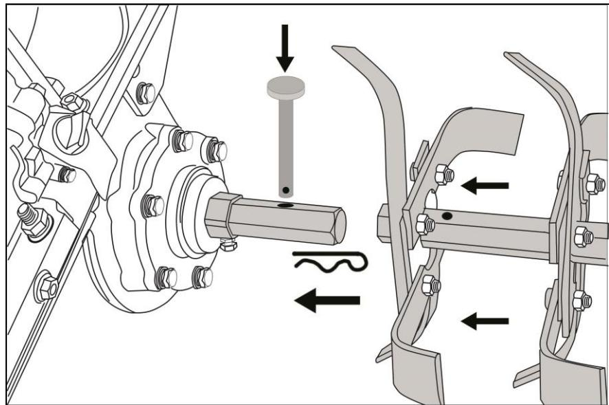
Рис. 6 Установка фрезы
