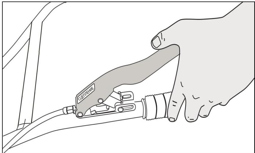
Рис. 27 Нажатие рычага сцепления
