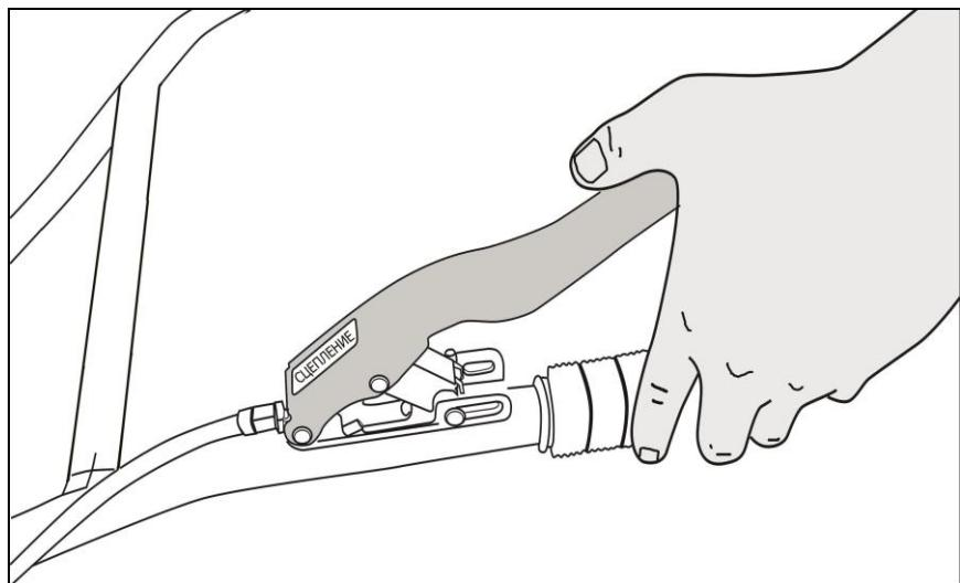
Рис. 30 Нажатие рычага сцепления
