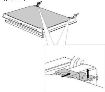
Немножко приподнимите фиксаторы с левой и правой стороны дверцы (символ 1 на фиксаторе) и потяните в стороны от стекла (символ 2 на фиксаторе).
