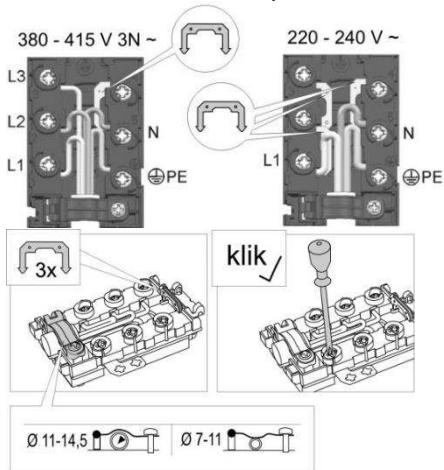
В случае неразъемного подключения к электросети установите до прибора размыкающее устройство с расстоянием между разомкнутыми контактами не менее 3 миллиметров.
