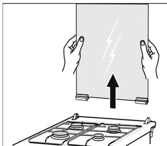
Если нужно снять и крепления крышки, обратите внимание на буквы на них. Крепление с буквой «R» должно быть установлено справа, крепление с буквой «L» - слева.
