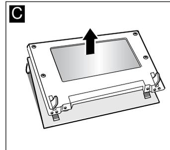
Снятые детали нельзя мыть. Протрите стёкла мягкой тряпочкой, смоченной средством для очистки стёкол.
