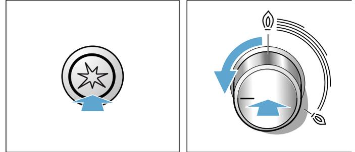
4. Нажмите переключатель конфорки до упора и удерживайте его нажатым в течение 1–3 секунд. Активируется система защиты от утечки газа. Благодаря этой системе при внезапно погасшем пламени автоматически прекращается подача газа.
