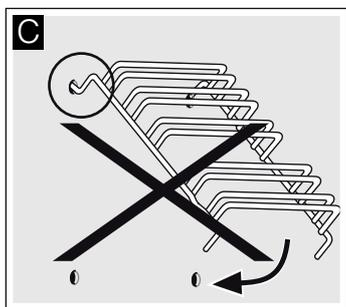
2. оба крючка должны быть полностью вставлены в верхние отверстия. Теперь можно медленно и осторожно опустить навесные элементы вниз и закрепить в нижних отверстиях (рис. D).
