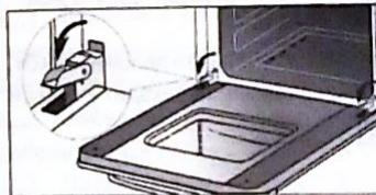
Дверцу духового шкафа полностью откройте и откиньте съемные язычки до упора назад. Затем медленно закрывайте дверцу, чтобы язычки уперлись в шарнирный узел на дверце.
