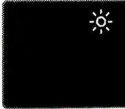
**Лампочка духового шкафа:** Загорается только лампа подсветки духового шкафа. Она горит на протяжении действия функции приготовления.
