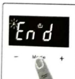
2. Нажмите кнопку "MODE" пока не отобразится символ "end" на экране дисплея. "A" и отобразится текущее время дня.
