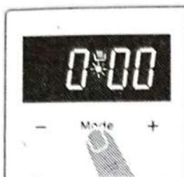
1. Нажмите кнопку "MODE" в течение 2 секунд для отключения блокировки кнопок и в центре экрана начнет моргать точка.
