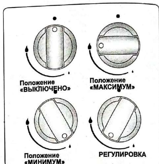
После зажигания визуально проверьте пламя. Если вы видите пламя с желтым верхом, приподнятое или неустойчивое пламя, выключите подачу газа и проверьте сборку крышек и насадок конфорок после их охлаждения.
