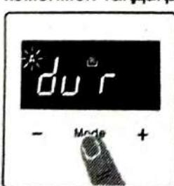
2. Экранда «dur» таңбасы пайда болғанша «MODE» түймесін басыңыз. «A» таңбасы жыптылыштайды.
