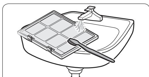
3. Для чищення фільтра використовуйте щітку та проточну воду.
