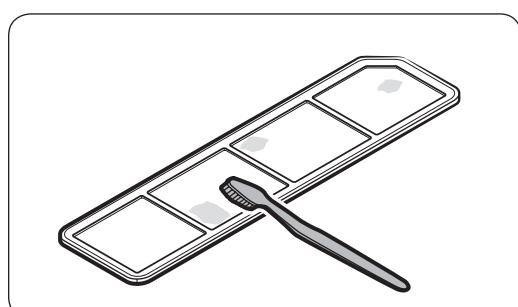
3. Для чищення фільтра для затримки ворсу використовуйте щітку та проточну воду. Висушіть фільтр для затримки ворсу у тіні.
