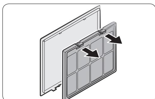
2. Затисніть два гачки у верхній частині фільтра та потягніть, щоб вийняти.
