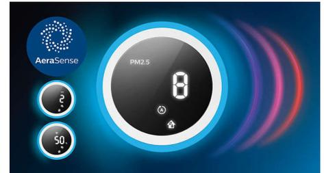
Датчик AeraSense сканирует воздух 1000 раз в секунду и быстро отображает данные о качестве воздуха в вашем доме. На дисплее отображается числовая концентрация аллергенов и частиц PM2.5, а цветное кольцо показывает общий уровень качества.
