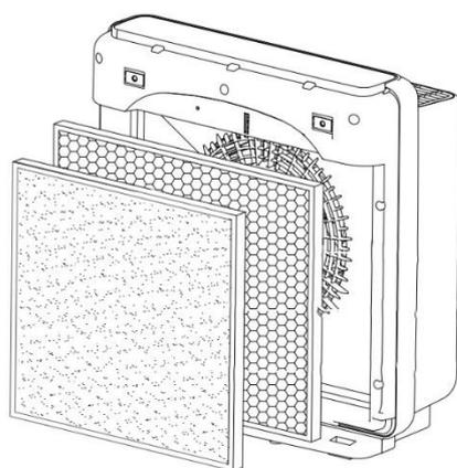
3. Последовательно вставьте новые фильтры. Сначала угольный фильтр, а затем РР и НЕРА фильтры (два фильтра находятся в одной планке)
