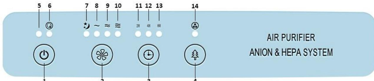
1. Кнопка включения и отключения прибора. При нажатии данной кнопки загорится символ низкой скорости и прибор начнёт работу.
