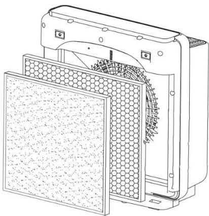
3. Последовательно вставьте новые фильтры. Сначала угольный фильтр, а затем PP и HEPA фильтры (два фильтра находятся в одной планке)
