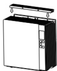
Рис. 7,8 Установите крышку. После замены фильтра и повторного запуска прибора нажмите «кнопку сброса» на задней панели прибора. Индикатор замены фильтра погаснет.
