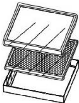
Рис. 3 Выньте отработанные фильтры из рамки
