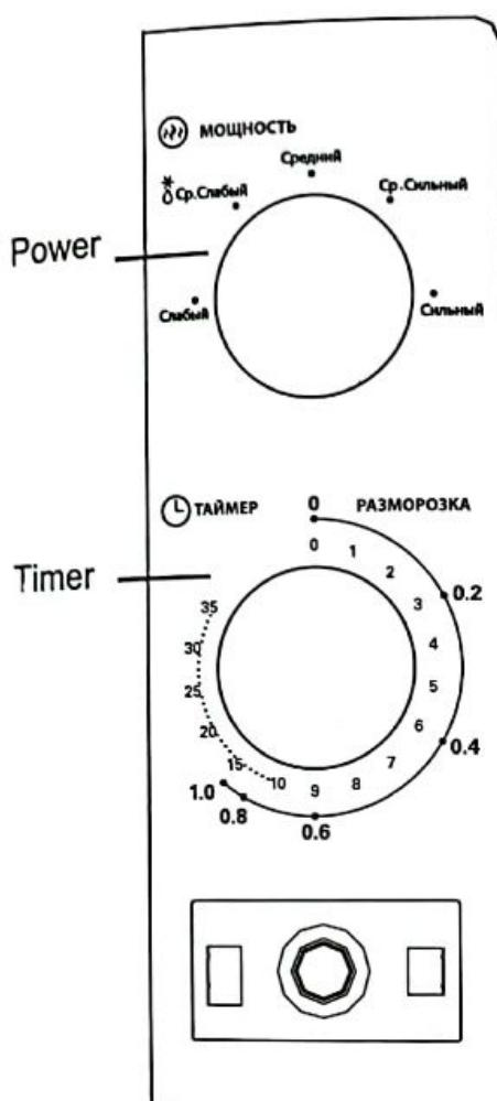
Панель управления состоит из двух функциональных операторов. Первый – рукоятка таймера, второй - рукоятка мощности.
