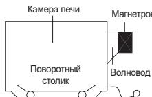
В микроволновой печи электричество преобразуется в микроволны МАГНЕТРОНОМ.
