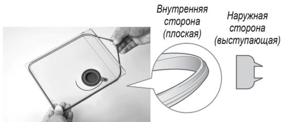
Надев резиновый уплотнитель на место, проверьте, чтобы он не был перевернут. Если установить его неправильной стороной, крышка не будет плотно закрываться и вода начнет протекать.
