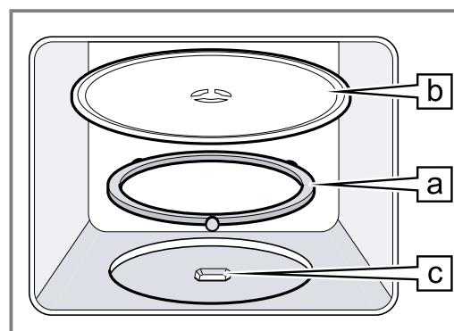
2. Fixați suportul rotativ în piesa de antrenare din centru din spațiul interior al cuptorului.
