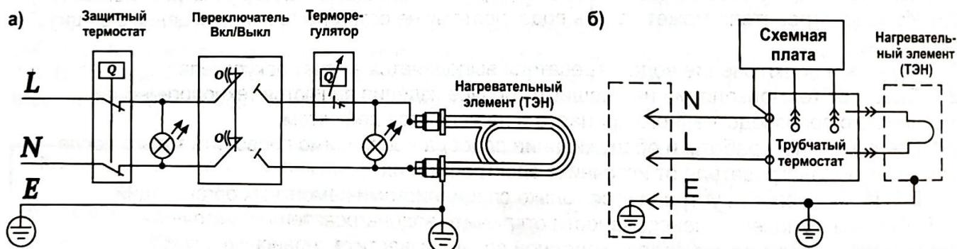
Рис. 4 Принципиальная электрическая схема водонагревателя:
