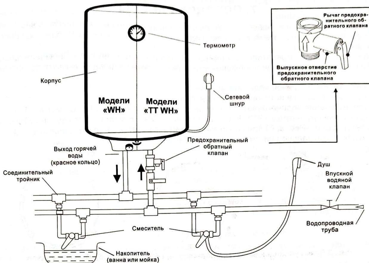
Рис. 1 Общая схема водонагревателя, подключенного к водоразборной точке
