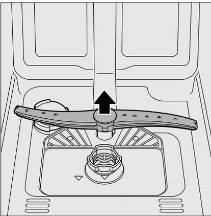
4. Промойте распылительные коромысла в проточной воде.
