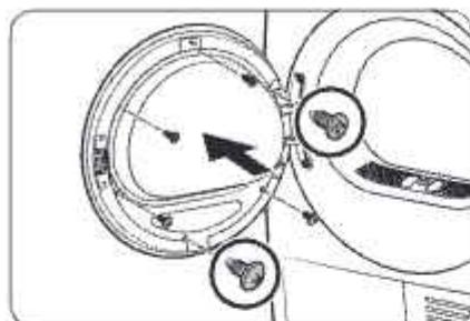
12. Затяните 3 крепежных винта в верхней части держателя. После этого затяните 3 крепежных винта в нижней части держателя.
