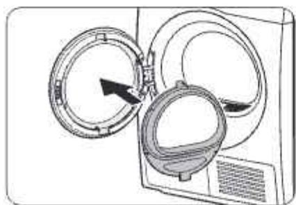
11. Вставьте держатель стекла в крышку дверцы, установленную на левую часть рамки.
