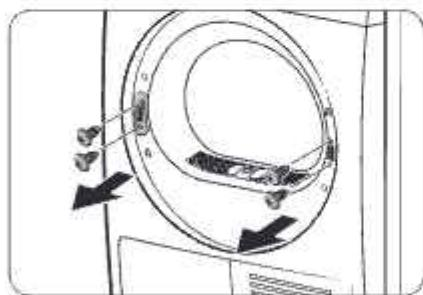
6. Открутите 2 винта кронштейна на правой части рамки, а затем открутите 2 крепежных винта на левой части рамки.
