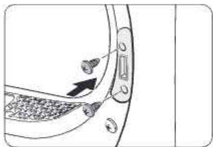
9. Вставьте держатель рычага в правую часть рамки, а затем затяните 2 крепежных винта.
