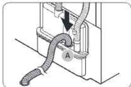
2. Вставьте один конец дополнительного шланга (длинный сливной шланг) в отверстие (A).
