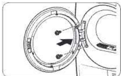
10. Вставьте петлю дверцы в другую часть рамки, а затем затяните 2 шурупа.
