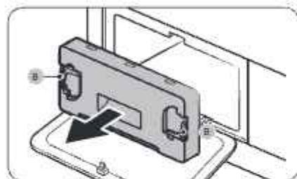
2. Разблокируйте фиксаторы (B) внутренней крышки, а затем потяните внутреннюю крышку, чтобы извлечь ее.
