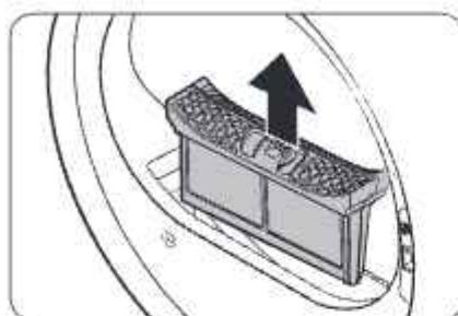
1. Откройте дверцу сушильной машины, возьмитесь за верхнюю часть фильтра для удаления ворсинок и потянните, чтобы вытянуть его.
