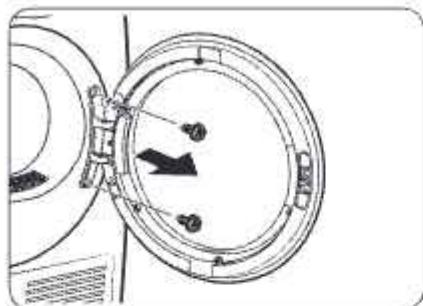
4. Открутите крепежные винты петли и снимите дверцу.
