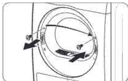
5. Открутите верхний винт с левой части рамки дверцы, а затем вставьте его в соответствующее отверстие на правой части рамки дверцы. Не откручивайте нижние винты кронштейна.
