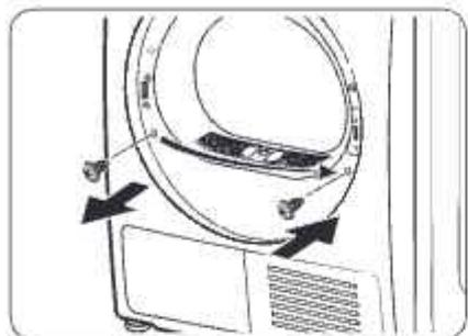
8. Открутите нижний винт с левой части рамки, а затем вставьте его в соответствующее отверстие на правой части рамки.
