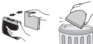
Снять и заменить засоренный выходной фильтр.
