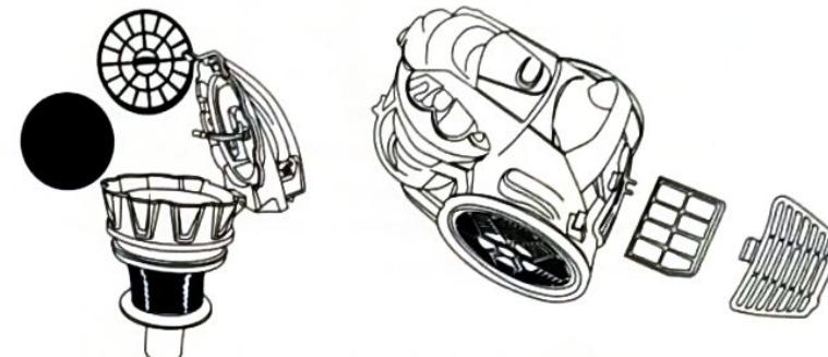
1. Пластиковый фильтр следует часто промывать, когда он загрязнен, чтобы избежать загрязнения.
