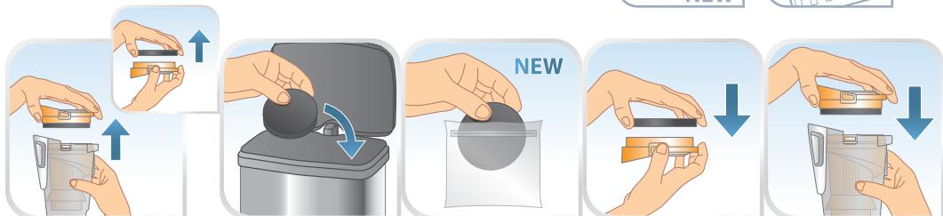
**PL** Filtr piankowy pojemnika na kurz należy wymieniać raz na 6 miesięcy. Należy zdjąć pokrywę pojemnika na kurz, wyjąć filtr piankowy, wyrzucić go i założyć nowy.
